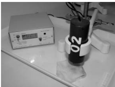
Porszívó filterében és léggömbbel összegyűjtött radioaktív por mérése Geiger-Müller-számlálócsővel.
