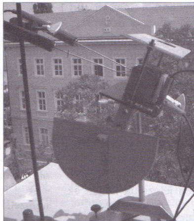
Az Ady Endre Közgazdasági Szakkollégium (Budapest) eszköze hagyományos hőmérővel, a Péchy Mihály Műszaki Középiskola (Debrecen) mérési összeállítása termoelemmel és függőös azimutszögméréssel, valamint azimutszögmérés a nyíregyházi Kölcsy Ferenc Gimnáziumban.
