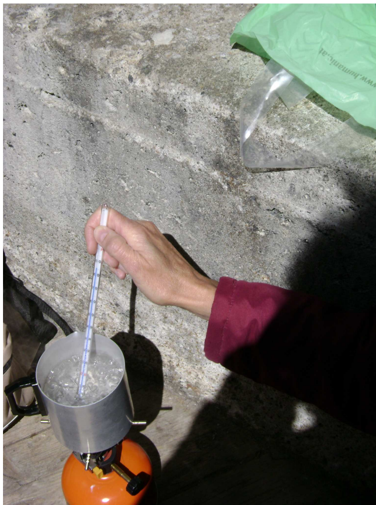
14. ábra. Forráspontmérés a Mont Blanc csúcsán, az Aiguille du Midin
